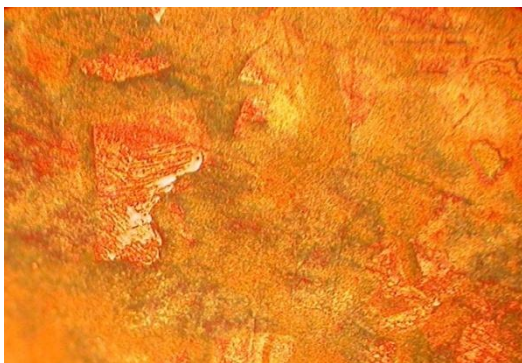
Рис. 3. Поверхность после обработки: электролит 1, \tau = 3 мин
