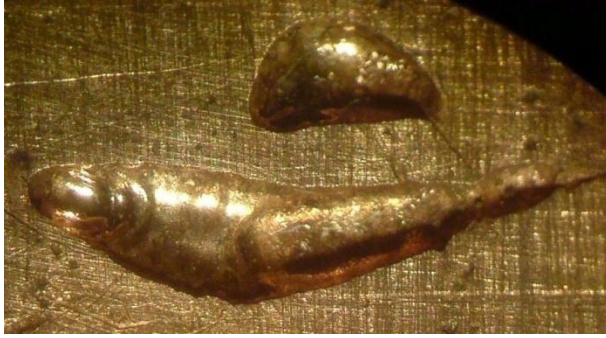
Рис. 5. Результат вытравливания рисунков «рыбка ()» длиной 2 мм и 7 мм в электролите 1, эксперимент 5
