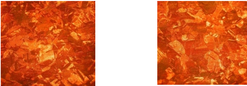
Рис. 9. Поверхность после обработки: электролит 3, \tau = 1 \text{ мин} , t = 40\text{--}50^\circ\text{C}
