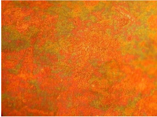
Рис. 2. Поверхность после обработки: электролит 1, \tau = 2 мин
