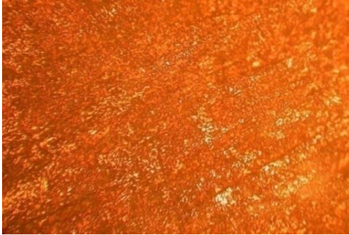
Рис. 12. Поверхность после обработки: электролит 2, \tau = 40 мин
