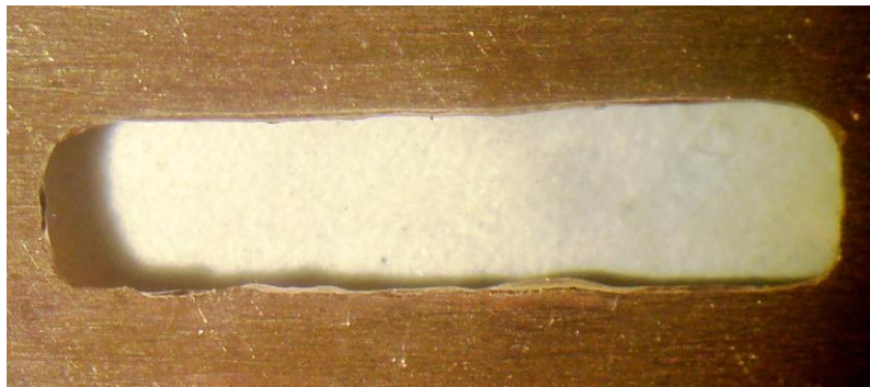
Рис. 7. Результат сквозного травления окна в образце толщиной 0,4 мм в электролите 1, эксперимент 7
