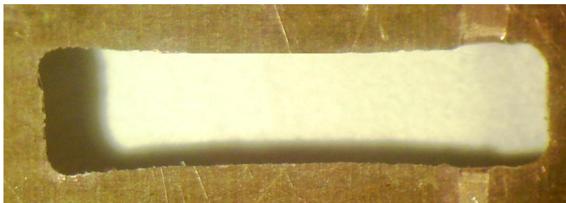
Рис. 12. Результат сквозного травления окна в образце толщиной 0,4 мм в электролите 1, эксперимент 12
