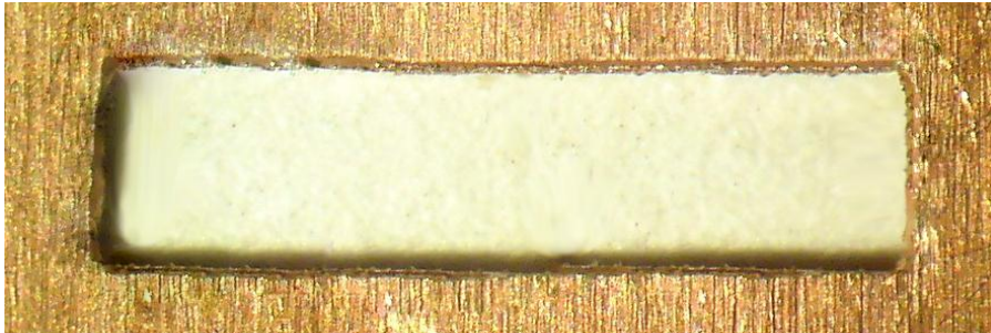
Рис. 13. Результат сквозного травления окна в образце толщиной 0,4 мм в электролите 1, эксперимент 13
