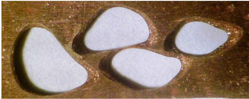
Рис. 6. Результат сквозного травления окон в образце толщиной 1 мм в электролите 1, эксперимент 6
